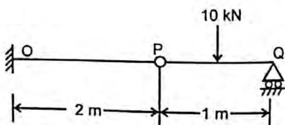
एक कैंटीलीवर धरन OP से दूसरी धरन PQ बिन्दु P पर पिन कनेक्ट है। चित्रानुसार PQ के मध्य बिन्दु पर 10 kN का बल लगा है। 'O' बिन्दु पर नमन बल आधूर्ण का मान, kNm में, होगा
