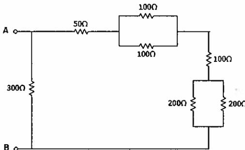
(a)  $1050\Omega$  (b)  $150\Omega$  (c)  $600\Omega$  (d)  $300\Omega$
